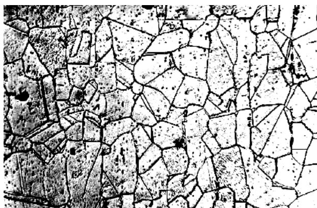
Рис. 5.23. Структура загартованої сталі I2X18H10T (аустеніт).
