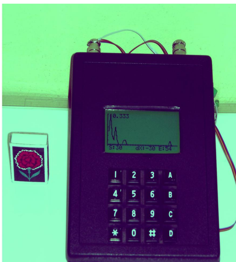
Рис. Д.2. Зовнішній вигляд старого комплексу (верхній рис.) та пристрою АЧР-БОШ-1 (аналізатор часу реакції Босенко-Орлик-Шумейко, нижній рис.). Авторський доробок [133]
