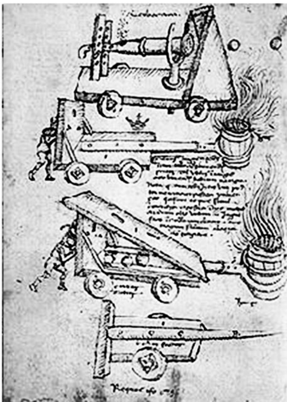
Рис. 12. «Секційний міст для річкової переправи» (1, 2) і «Мобільна сербатана» (3, 4) (1, 3 – за: CLM 288000, р. 15 v; 2, 4 – за: CLP 7239, fo. 19v, fo. 58v).
